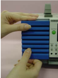
図 7-10ルーバの取り外し
