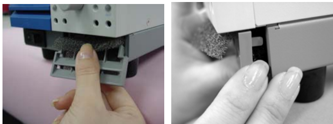
図 7-7 図ルーバの取り付け
