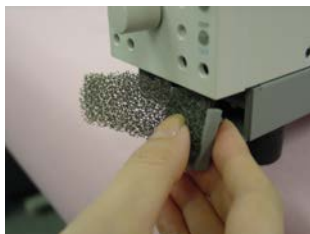
図 7-3 ルーバの取り付け
