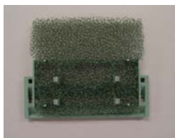
図 7-6 ダストフィルタの取り付け
