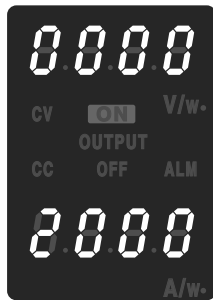
図 5-4 直列運転スレーブ機の設定例
