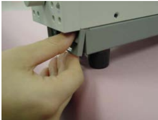
図 7-1 ルーバの取り外し
